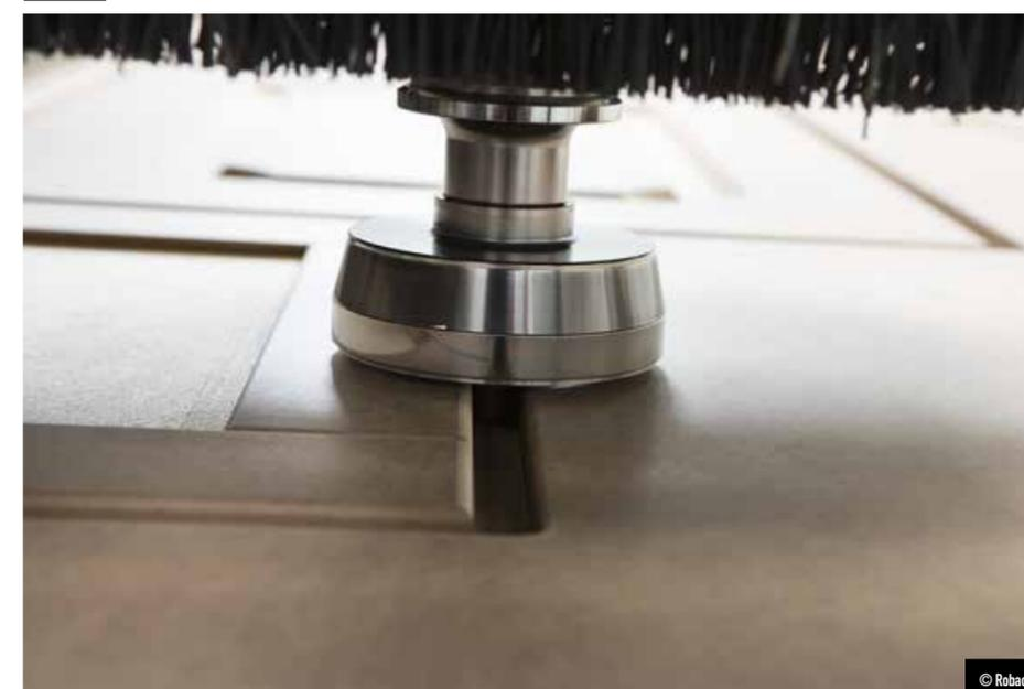
Pour vous faire une idée : Aerotech® est équipé d'une fraise de Ø 14 mm; s'utilise pour l'usinage de panneaux MDF d'une épaisseur de 18 mm; selon un système à 3 équipes (220 jours de production); élimine 8,4 tonnes de poussière et supprime le besoin d'air comprimé et d'extracteurs.
