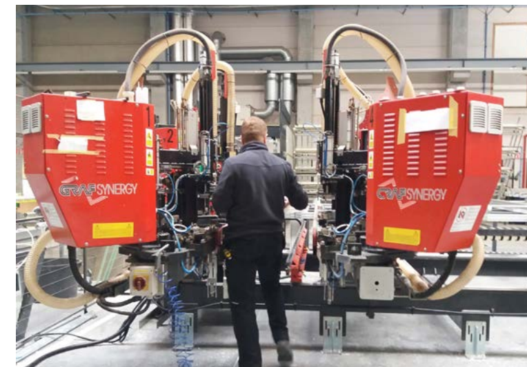
Une machine à souder à 4 têtes constitue l'investissement le plus récent.
