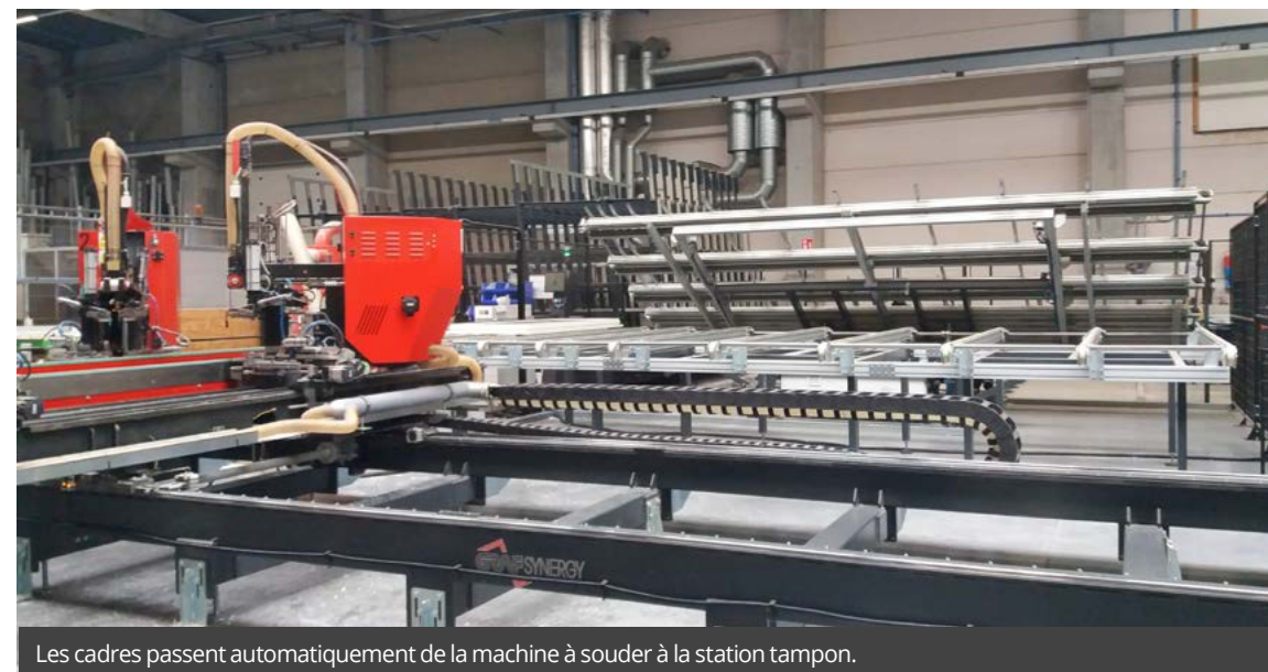
Les cadres passent automatiquement de la machine à souder à la station tampon.
