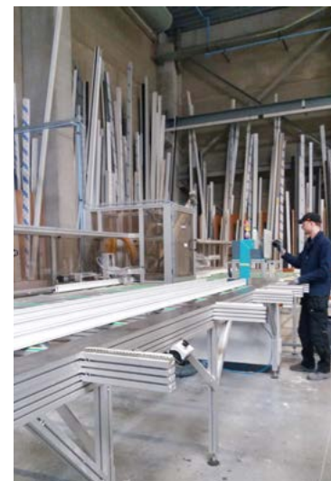
Les profilés sont sciés à longueur en optimisant les découpes.
